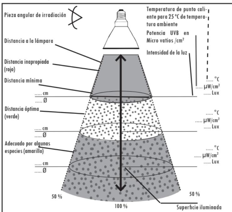
Por favor, tenga en cuenta que la cantidad de luz ultravioleta por superficie irradiada depende mucho de la distancia a la lámpara. La división de la distancia multiplica teóricamente la fuerza de irradiación y al revés. Con 20 cm de distancia es la dosis de luz ultravioleta cuatro veces más alta, como con 40 cm. Por ese motivo debe usted por seguridad cumplir estrictamente con sus animales las indicaciones de distancia.
