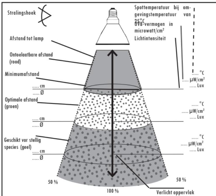
Houd er rekening mee dat de UV-hoeveelheid per bestraald oppervlak erg afhangt van de afstand tot de lamp. Bij de halvering van de afstand verviervoudigt zich in theorie de stralingssterkte en vice versa. Bij een afstand van 20 cm is de UV-dosis dus viermaal hoger dan bij 40 cm. Voor de veiligheid van uw dieren dient u daarom de afstanden strikt te handhaven.
