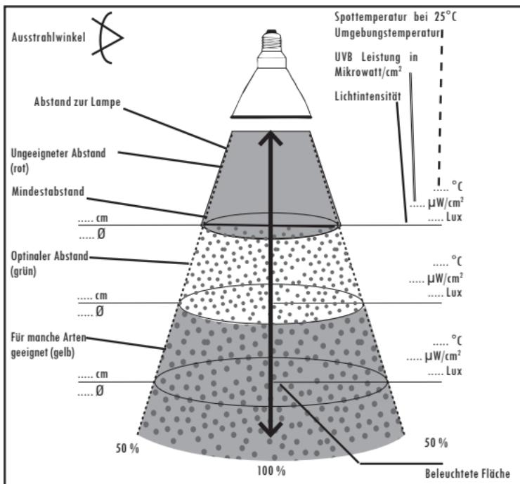
Bitte beachten Sie, dass die UV-Menge pro bestrahlter Fläche sehr stark von der Entfernung zur Lampe abhängt. Bei der Halbierung der Entfernung vervierfacht sich theoretisch die Bestrahlungsstärke und umgekehrt. Bei 20 cm Abstand ist die UV Dosis also viermal so hoch, wie bei 40 cm. Aus diesem Grund sollten zur Sicherheit Ihrer Tiere die Angaben zu Abständen unbedingt eingehalten werden!
