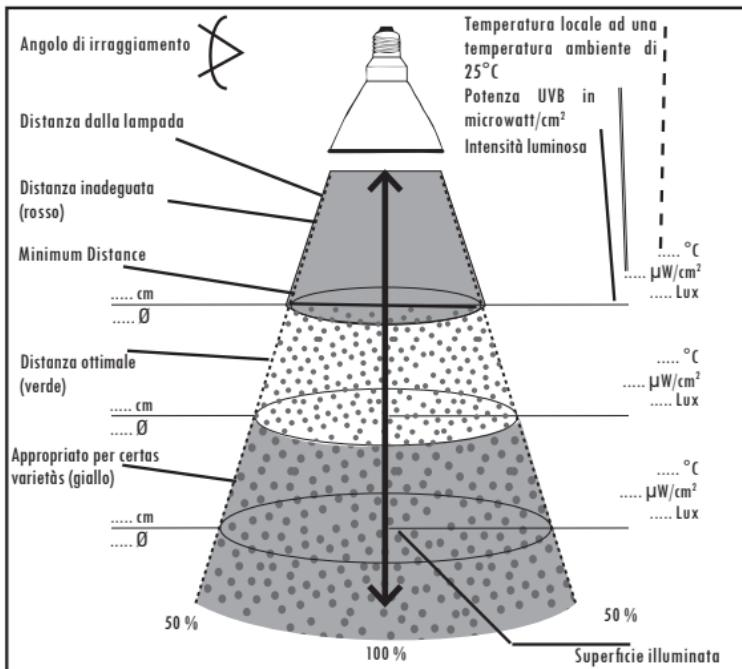
I prego di osservare che la quantità di UV per superficie illuminata dipende in modo significativo dalla distanza dalla lampada. Dimezzando la distanza si quadruplica teoricamente la potenza di irraggiamento e viceversa. Ad una distanza di 20 cm la dose di UV è quindi quattro volte superiore, come a 40 cm. Per questo motivo è necessario rispettare scrupolosamente le indicazioni sulle distanze, per la sicurezza dei vostri animali!
